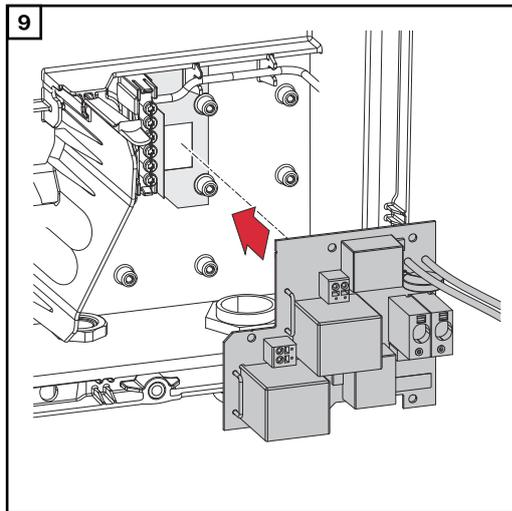
Den Print in den Wechselrichter einsetzen.
