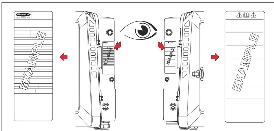
Am Leistungsschild ganz unten wird eine 4-stellige Ziffer (coded production date) angedruckt, aus der das Produktionsdatum berechnet werden kann. Wenn man von den ersten beiden Ziffern den Wert 11 abzieht, erhält man das Produktionsjahr. Die letzten beiden Ziffern stehen für die Kalenderwoche, in der das Gerät produziert wurde.
