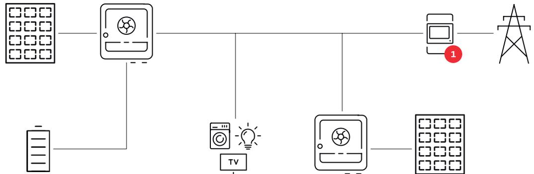
**Energiefluss-Richtung des Wechselrichters**
