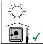
Den Wechselrichter an einer geschützten Position montieren, z. B. unterhalb der Solarmodule oder unter einem Dachvorsprung.
