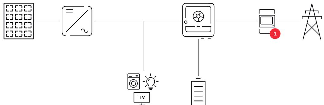
**Betriebsmodus - Wechselrichter mit Batterie und Ohmpilot**
