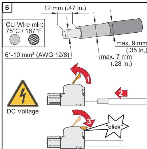
Kabel-Querschnitt gemäß der Angaben in [Zulässige Kabel für den elektrischen Anschluss](#) ab Seite 55 wählen. Von den Einzelleitern 12 mm abisolieren. Den Betätigungshebel der Anschlussklemme durch Anheben öffnen und den abisolierten Einzelleiter in den jeweils vorgesehenen Steckplatz bis zum Anschlag in die Anschlussklemme stecken. Danach den Betätigungshebel bis zum Einrasten schließen.
