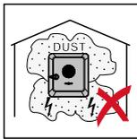
Grundsätzlich ist der Wechselrichter staubdicht (IP 66) ausgeführt. In Bereichen mit starker Staubansammlung können sich Staubablagerungen auf den Kühlflächen ansammeln und somit die thermische Leistungsfähigkeit beeinträchtigen. In diesem Fall ist eine regelmäßige Reinigung erforderlich siehe Kapitel [Betrieb in Umgebungen mit starker Staubentwicklung](#) auf Seite 165. Eine Montage in Räumen und Umgebungen mit starker Staubentwicklung ist daher nicht zu empfehlen.
