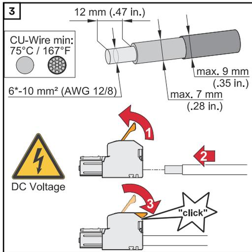
\* Der min. Kabel-Querschnitt ist aus der Bedienungsanleitung des Batterieherstellers zu entnehmen.
