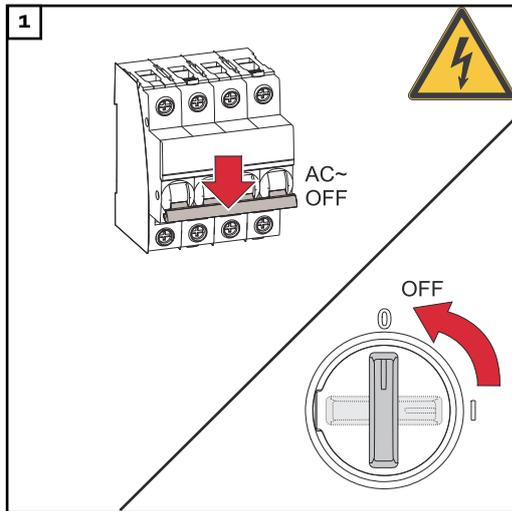
Den Leitungs-Schutzschalter ausschalten. DC-Trenner in die Schalterstellung „Aus“ stellen.
