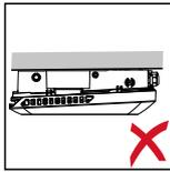
Den Wechselrichter nicht an der Decke montieren.
