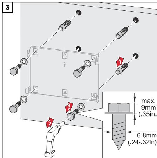
**Montagehalterung auf einem Mast oder Träger montieren**
