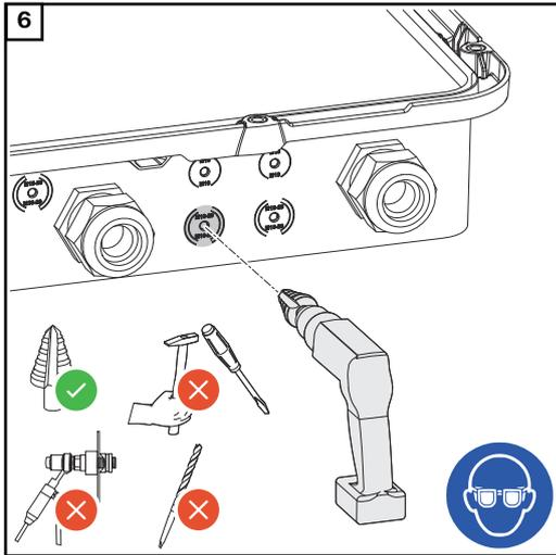
Die optionale Kabeldurchführung mit einem Stufenbohrer aufbohren.
