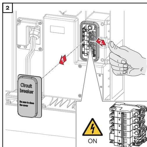
Abdeckung des DC-Trenners nach vorne abziehen. Den DC-Trenner in die Schalterstellung „Ein“ stellen.
