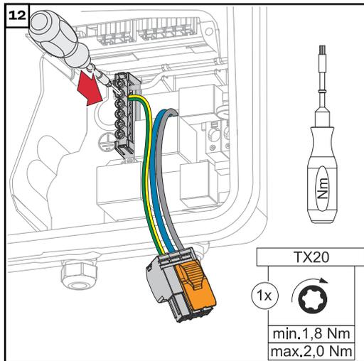
Die mitgelieferte PEN-Verbindung am zweite Eingang von oben an der Erdungselektroden-Klemme mit einem Schraubendreher (TX20) und einem Drehmoment von 1,8 - 2 Nm befestigen.
