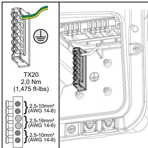
Die Erdungselektroden-Klemme bietet die Möglichkeit, weitere Komponenten zu erden, wie z. B.:
