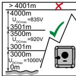
Der Wechselrichter darf über einer Seehöhe von 4 000 m nicht mehr montiert und betrieben werden.
