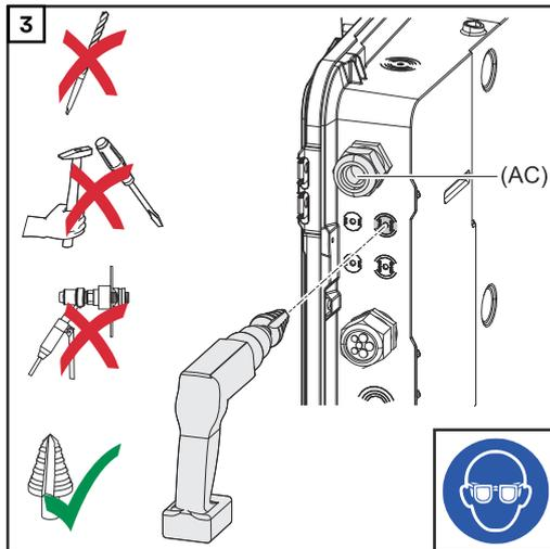
Die optionale Kabelführung mit einem Stufenbohrer aufbohren.
