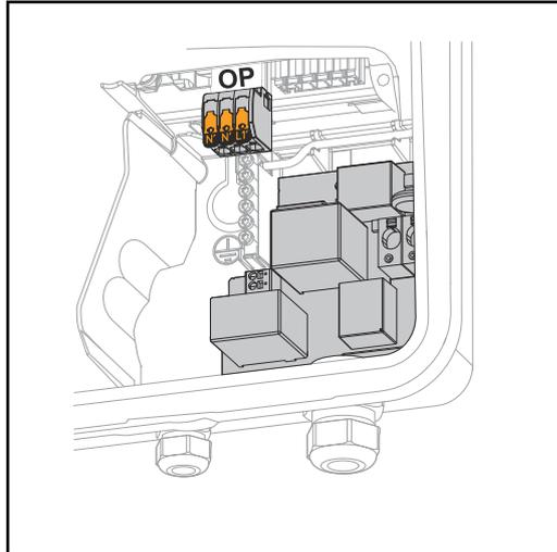
Mit dem PV Point Comfort werden 1-phasige elektrische Geräte bis zu einer max. Leistung von 3 kW dauerhaft versorgt.
