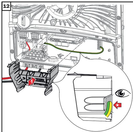
Abtrennung des Anschlussbereichs wieder einsetzen.
